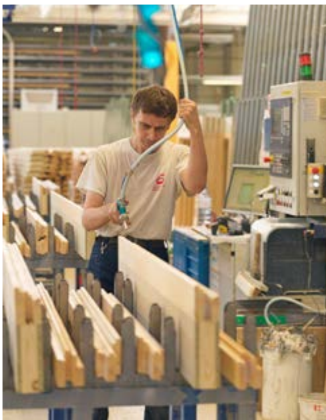
Genaueres Arbeiten ist entscheidend: Miki Anbjelkovic gibt Leim an, bevor er die Rahmenteile in die Presse legt.
